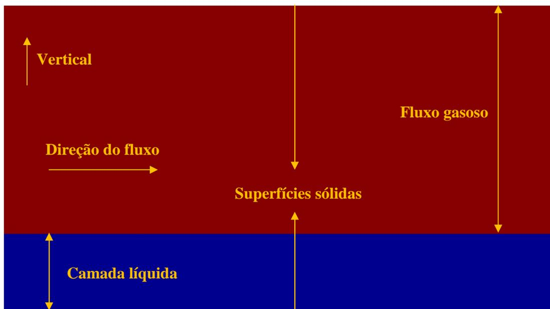
**Figura 3.1.2.1: Geometria criada para representar bidimensionalmente a câmara de combustão de um motor híbrido (obtido com *Gerris Flow Solver* [6])**
