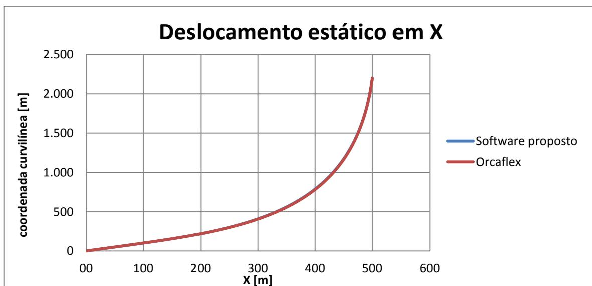
Figura 9.11 - Configuração estática do *riser* estudado, estudo de caso 2, para o *software* comercial *Orcaflex* e o proposto.
