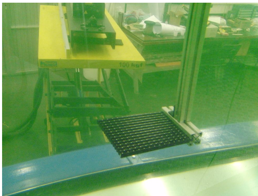
Figura 11. Canhões de laser posicionados de acordo com a placa de calibração.
