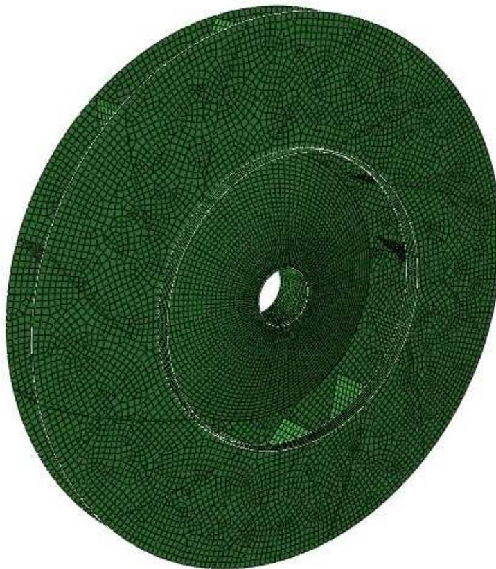
Figura 27 – Malha do ventilador em estudo com elementos de casca.
