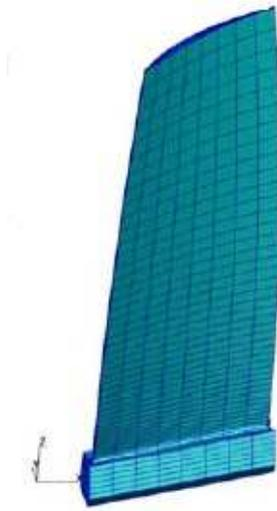
Figura 9 – Modelo em elementos finitos de uma pá (WITEK, 2009).
