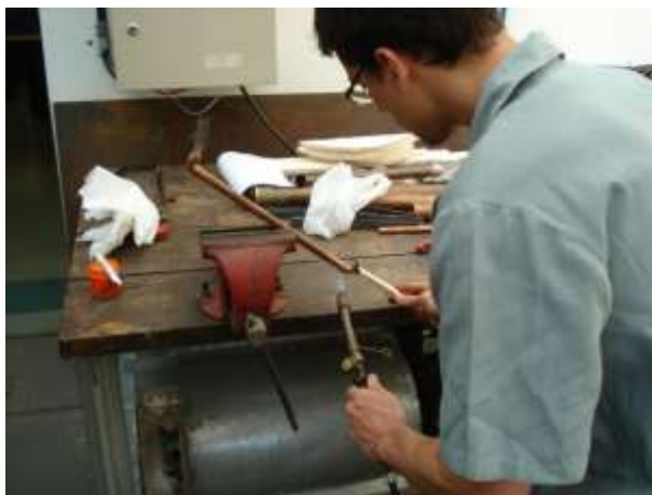
Figura 35 - Soldagem dos tubos de cobre
