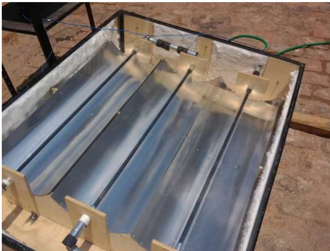
Figura 40 - Coletor solar em funcionamento
