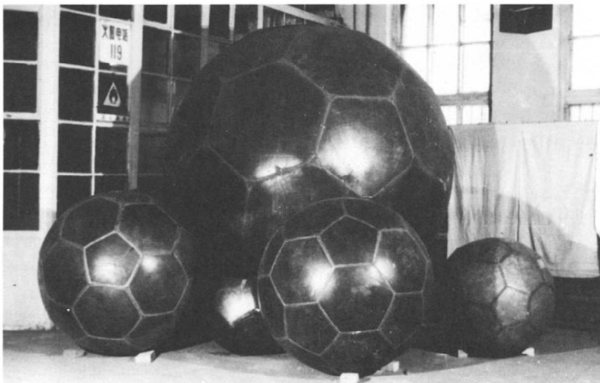
Figura 16 - Esferas fabricadas com processo de hidroconformação a partir de poliedros. Extraído de (WANG, 1988).
