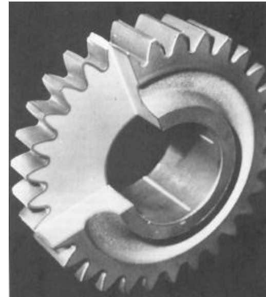
Corte de uma engrenagem cementada
