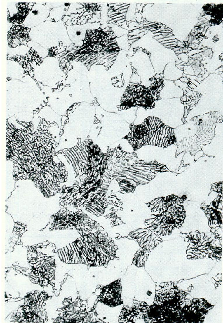
Microestrutura de um aço 0,38% C resfriado lentamente (em condições próximas ao equilíbrio).
