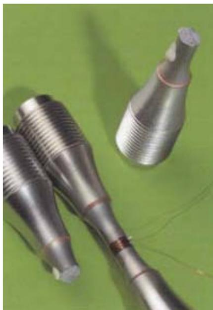
Ensaio de fadiga a quente em material resistente ao calor
