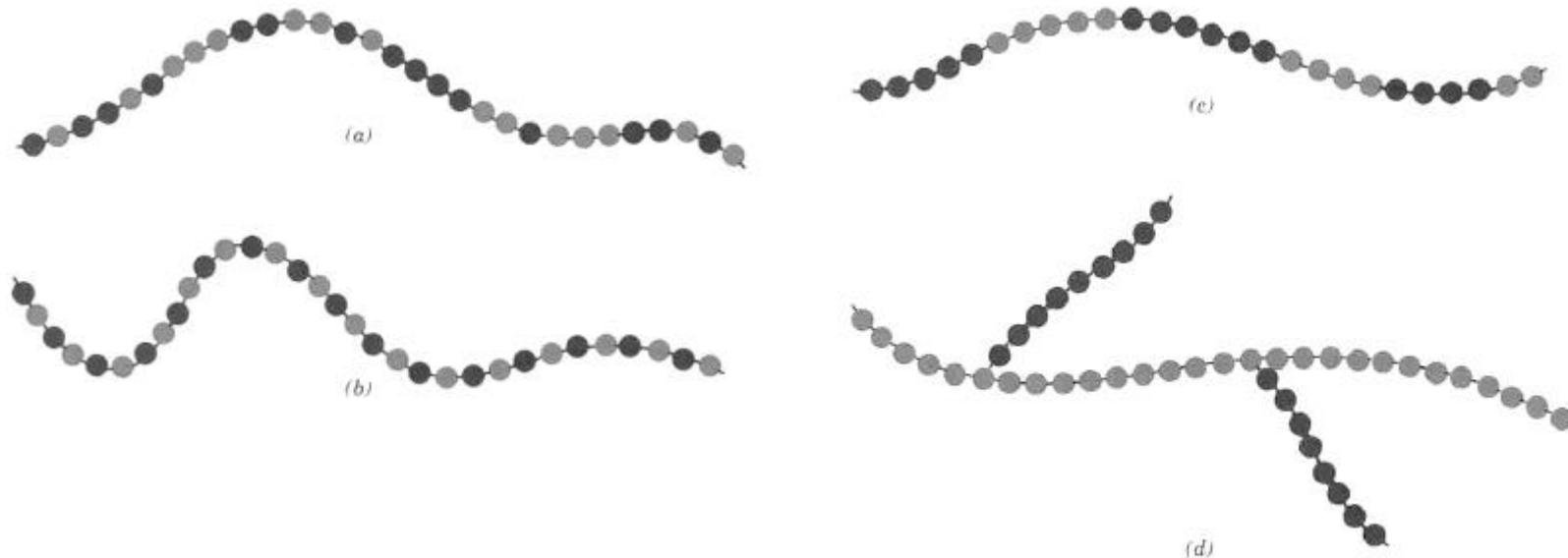
*Tipos de distribuição dos diferentes monômeros nas moléculas dos copolímeros: (a) aleatória, (b) alternada, (c) em bloco e (d) ramificada*
