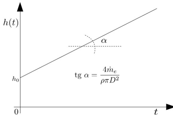
Figura 4: Perfil do nível de líquido no tanque em função do tempo.
