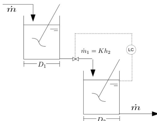
Figura 6: Sistema de dois tanques.
