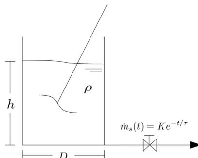
Figura 5: Esgotamento de um tanque.
