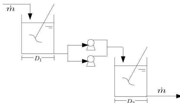
Figura 8: Sistema de dois tanques com bombas em paralelo.
