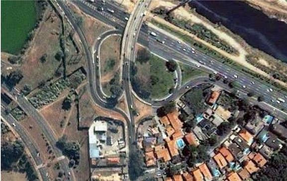
A implantação de uma nova Pte. (custo estimado de 100milhões para uma seção de 23m com extensão de 300m), elimina a necessidade do trecho em mão inglesa e gera diversas opções de configuração, de acessos e de entrelaçamentos. A opção com sentido único nas pontes, alça de entrada e saída direcional é mostrada abaixo (admita que cada ligação direcional reduz a distância de entrelaçamento em 100m):
