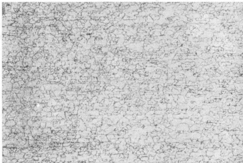
Fig. n.º 22 — Aspecto micrográfico de aço inoxidável ferrítico com 17,2 % Cr e 0,07 % C. Aumento 100X. (Fotografia extraída do livro “Engineering Physical Metallurgy”).
