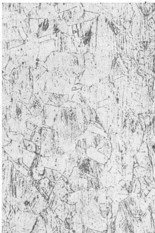
Fig. n.º 26 — Aspecto micrográfico de um aço inoxidável com 18,5 % Cr, 9 % Ni temperado de 1090°C e reduzido de 20 % por laminação a frio. Dureza Rockwell 30C. Aumento 100X. (Fotografia extraída do livro “Engineering Physical Metallurgy”).
