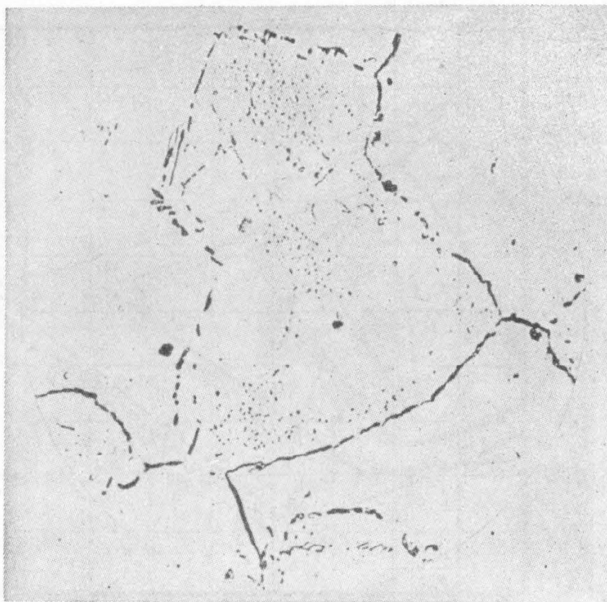
Fig. n.º 8 — Aspecto micrográfico de uma liga com 0,10 % C e 16,7 % Cr, esfriada muito lentamente de 870°C. Aumento 700X. (Figura extraída do livro “The Book of Stainless Steels”).
