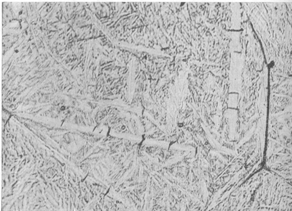
Fig. n.º 13 — Micrografia mostrando rachas de têmpera em peças cementadas e temperadas em água — 1000X.
