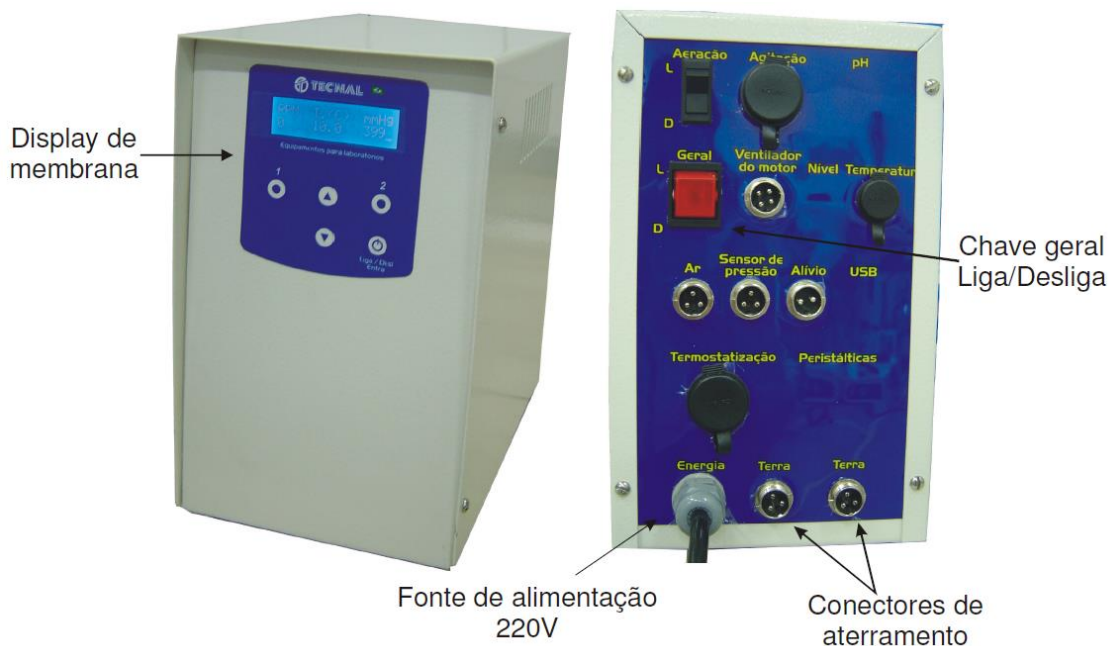
Figura 5.3: Módulo de medição e de atuação do biorreator (TEC-BIO-PLUS) parcialmente alterado
