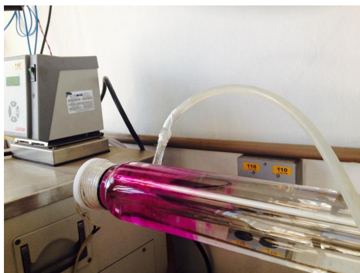
Figura 31 - Mistura na região da alimentação do reator
