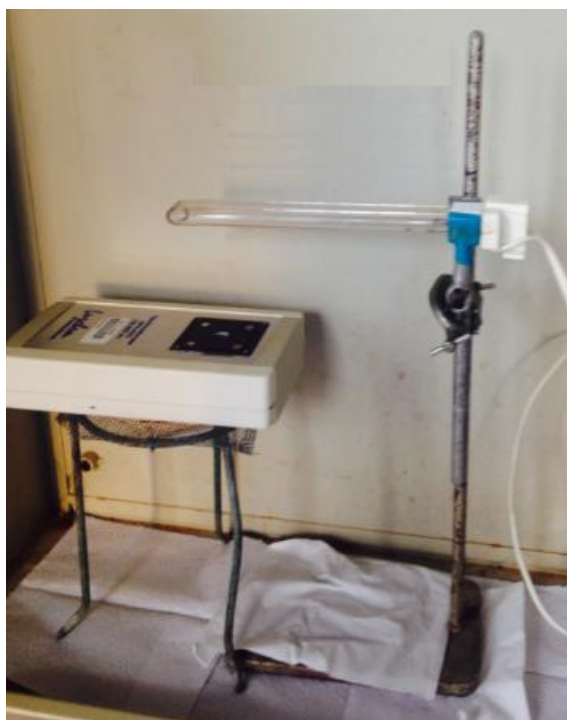
Figura 6 - Montagem do espectrorradiômetro simulando a irradiação na cubeta.
