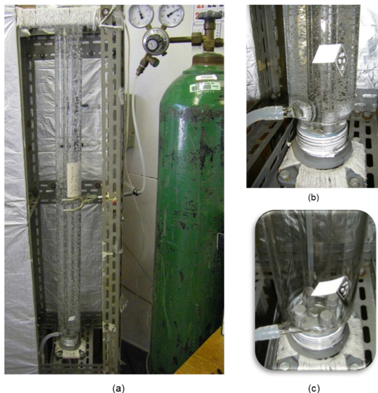
Figura 4: O reator tubular (coluna de bolhas para contato gás-líquido) vertical em vidro, com comprimento de 1000 mm e diâmetro interno 75 mm. A Figura (a) mostra uma visão geral da coluna em funcionamento. A Figura (b) destaca as bolhas de mistura gasosa contendo ozônio. A Figura (c) O reator conta com quatro difusores em teflon diametralmente opostos, capazes de distribuir o gás homoganeamente sob a forma de bolhas de pequeno tamanho.
