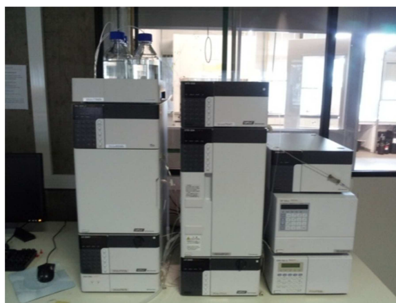
Figura 5: Equipamento de cromatografia líquida (HPLC) equipado com detector de fluorescência RF-10AXL.
