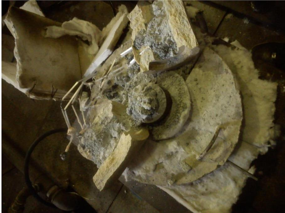
Figura 16. Resultado típico de experimento com escória ES1 observado minutos após o vazamento, evidenciando luva quebrada e pulverização da escória.
