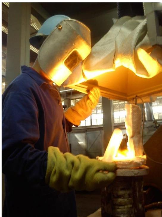
Figura 11. Carregamento do Forno com a Mistura de Óxidos.
