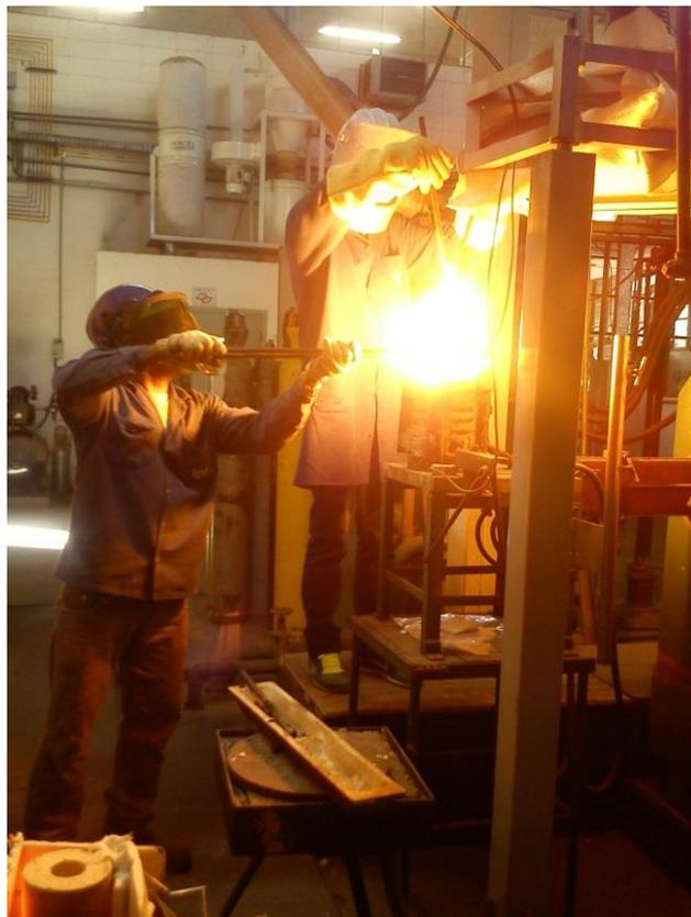
Figura 13. Retirada do cadinho do forno.
