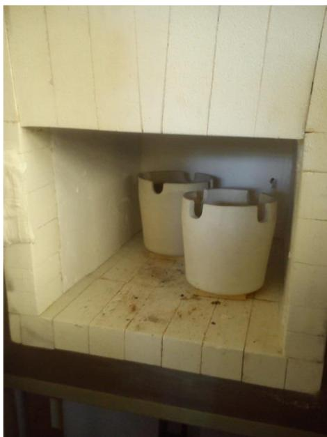
Figura 7. Interior do Forno para Calcinação do Carbonato de Cálcio.
