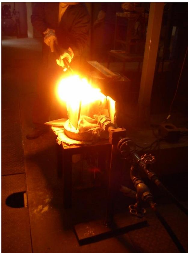
Figura 14. Vazamento da escória em luva refratária resfriada.
