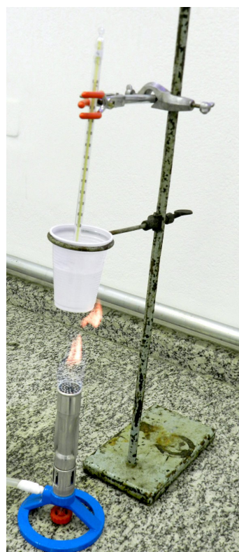
Figura 41: Exposição de um copo plástico cheio de água à chama de um bico de Bunsen
