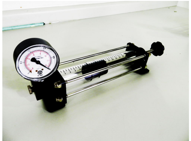
Figura 10: Boyle-Marriote comprimido em volume menor que inicial, com pressão relativa máxima dentro da escala de leitura
