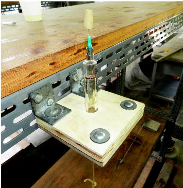
Figura 11: Seringa de vidro na posição vertical fixada em uma base de madeira
