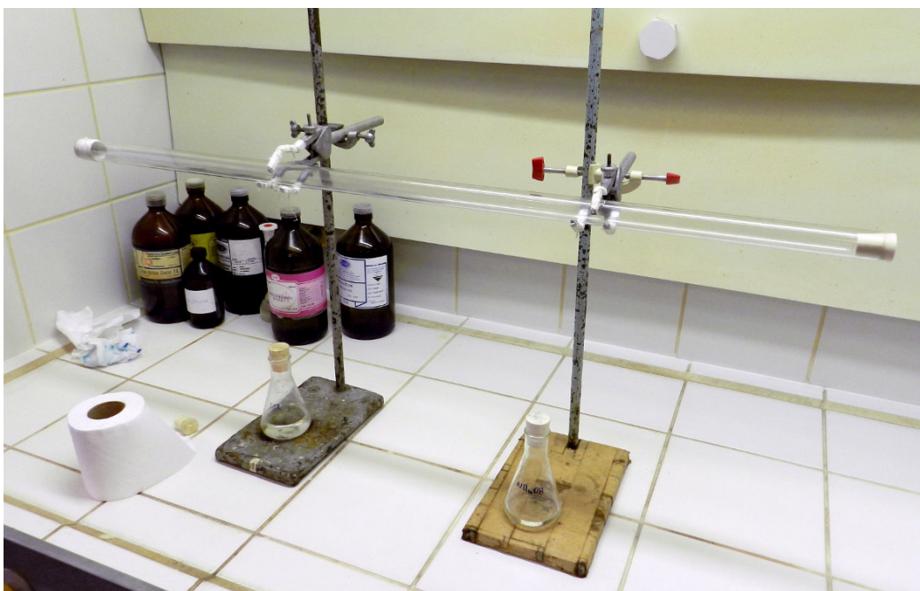
Figura 38: Montagem geral do tubo contendo algodões embebidos com reagentes em suas extremidades
