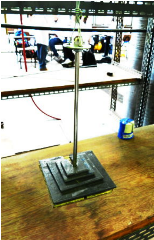
Figura 14: Blocos de chumbo carregados no suporte
