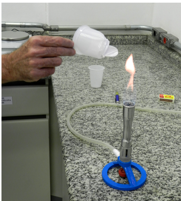
Figura 42: Exposição de um copo plástico vazio à chama de um bico de Bunsen
