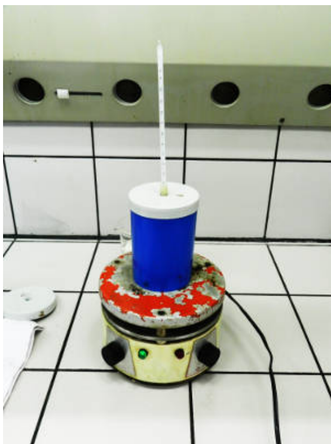
Figura 4: Béquer com calorímetro reagindo a baixa agitação
