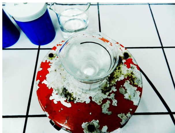
Figura 5: Béquer sem calorímetro reagindo a baixa agitação
