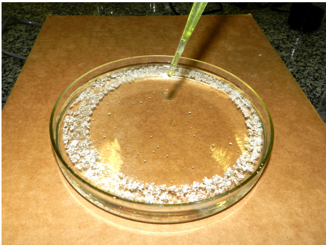
Figura 32: Dispersão do pó de giz após o derramamento de uma gota de tensoativo
