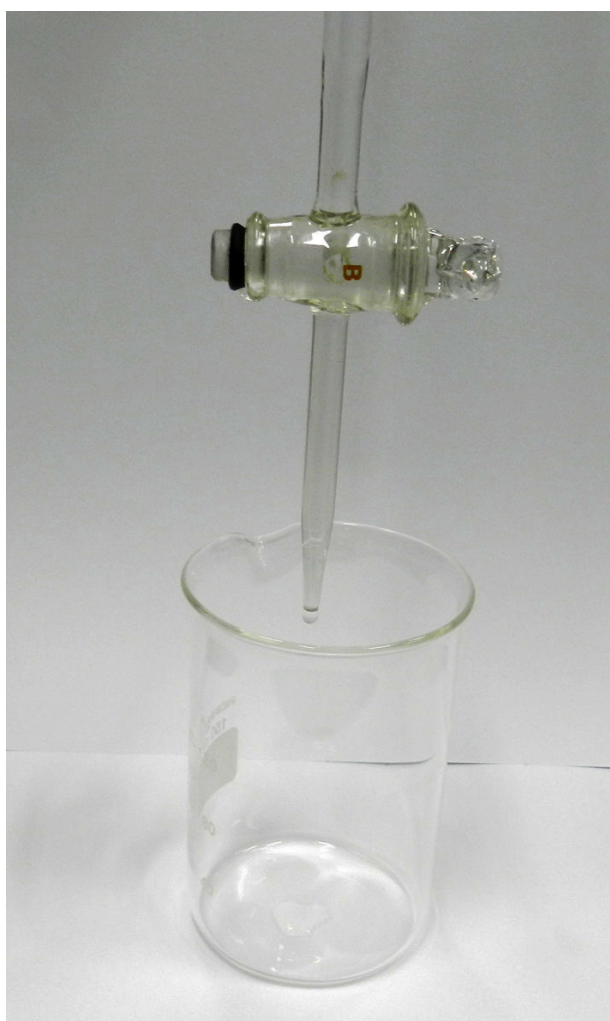
Figura 24: Montagem experimental do método da queda de gota
