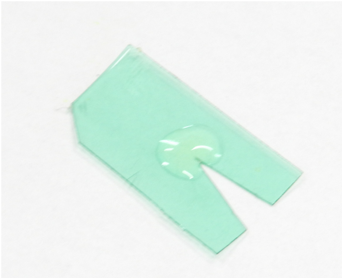
Figura 33: Barco de plástico PET com gota de tensoativo em sua traseira
