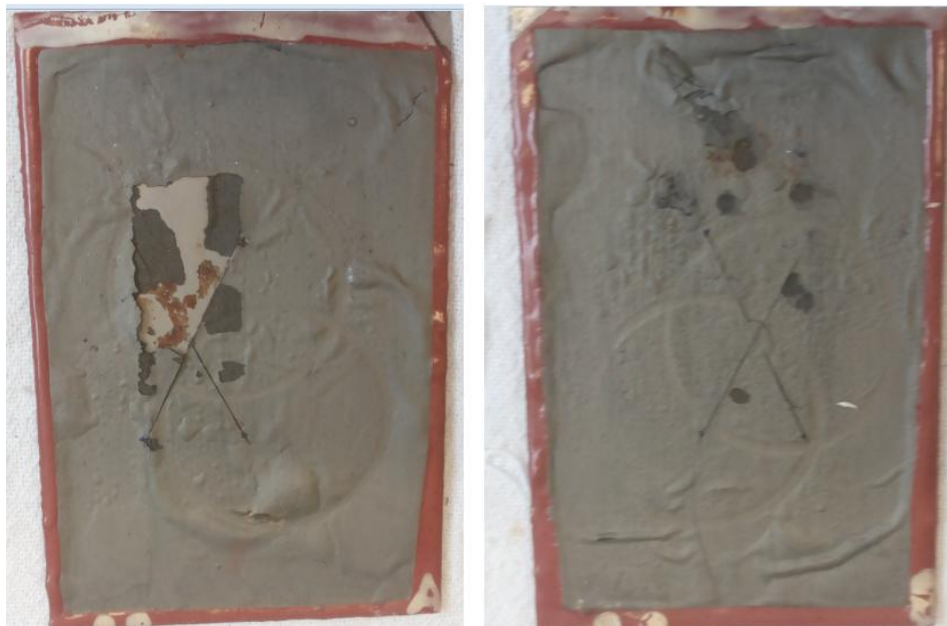
Figura 23. Teste de aderência nas amostras "A" e "B" depois da retirada da fita adesiva
