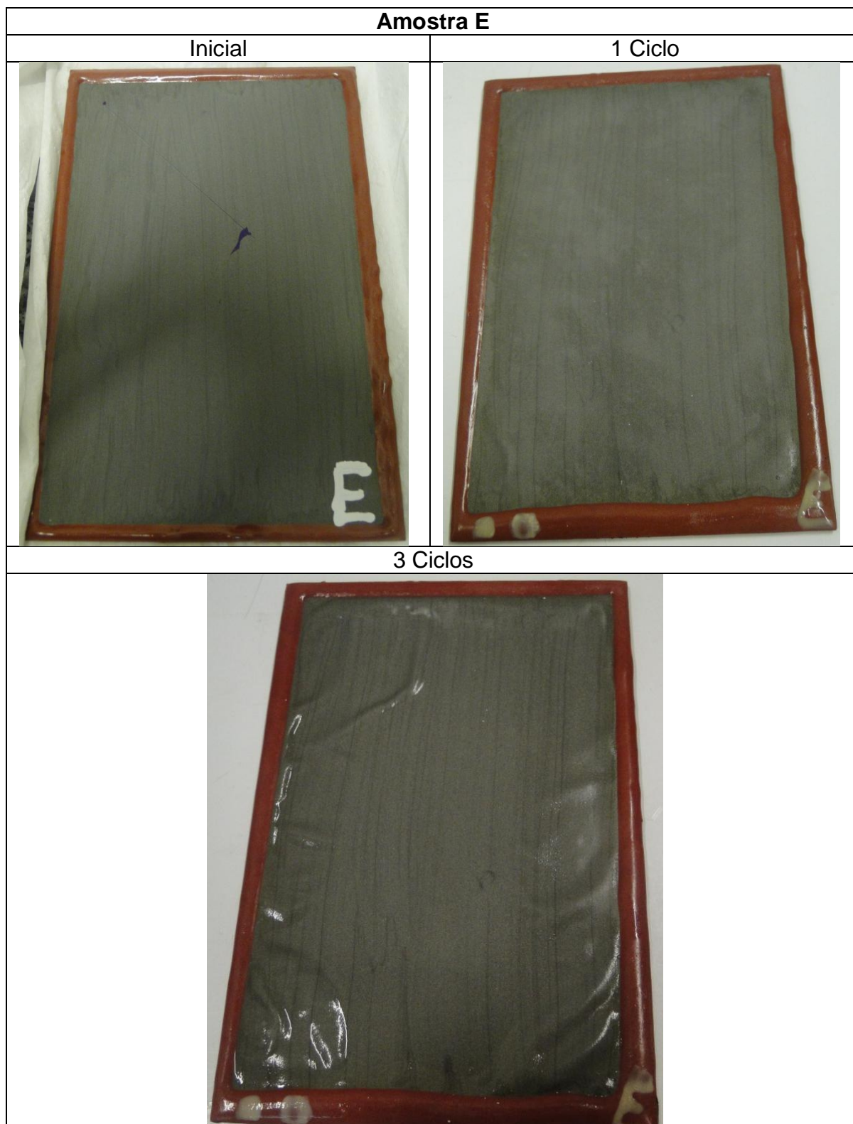
Figura 31. Amostra alquílica "E" sem microesferas de PCLantes do choque térmico (inicial), após 1 e 3 ciclos
