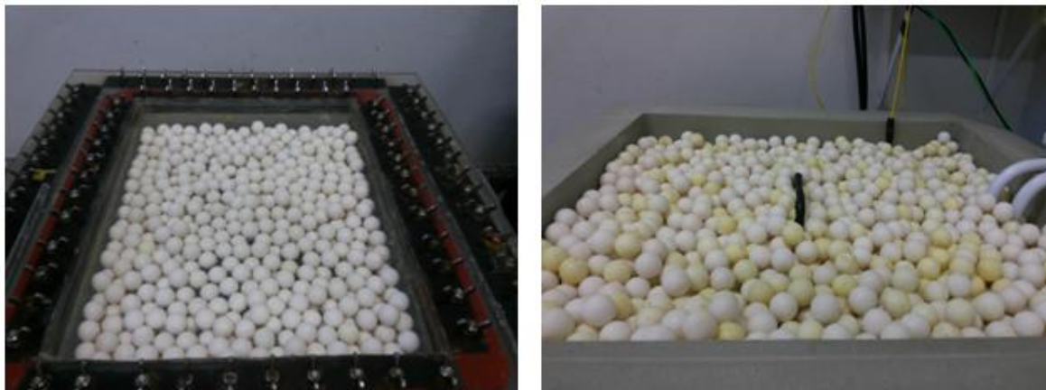
Figura 19. Cubas recobertas com esferas isolantes: (a) cuba de resfriamento b) cuba de aquecimento
