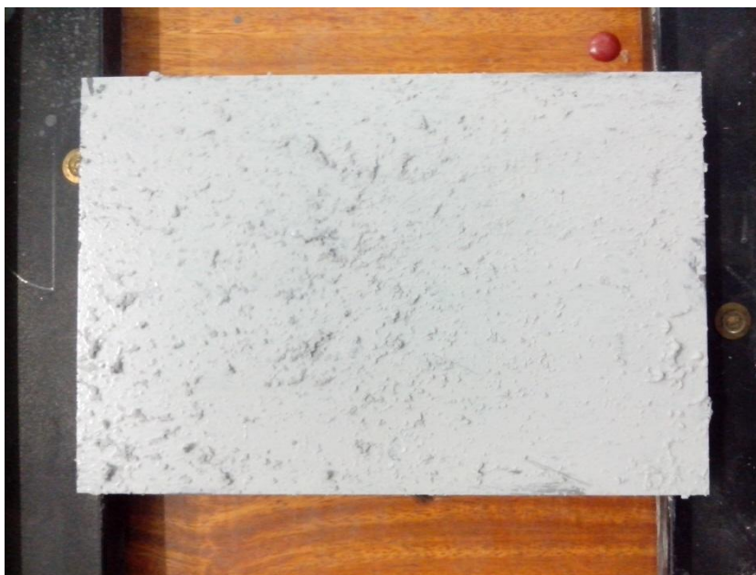
Figura 17. Placa de aço carbono revestida de tinta epóxi aditivada com microesferas de PCL
