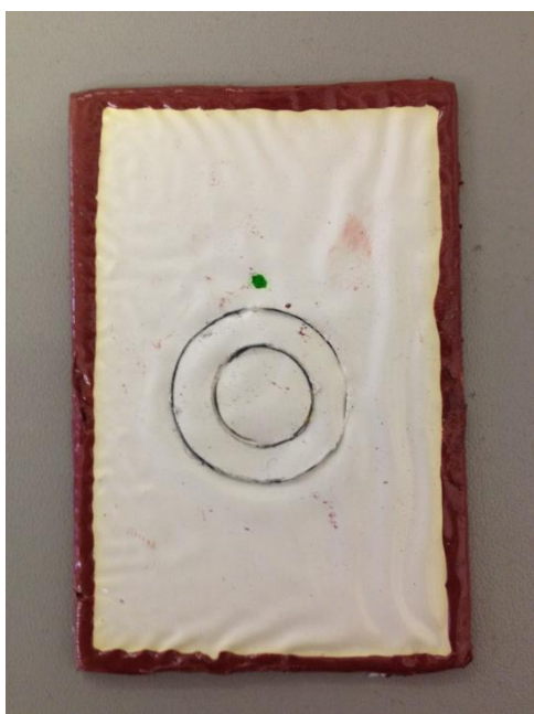
Figura 24. Dano mecânico em placa com revestimento de tinta alquídica
