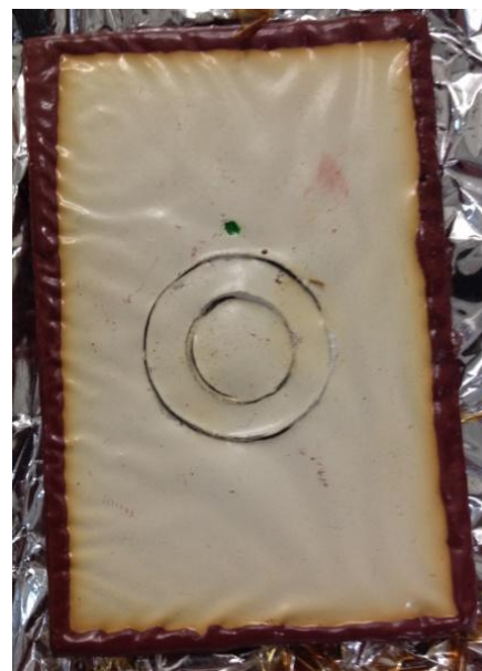
Figura 35. Dano mecânico após choque térmico em placa com revestimento de tinta alquídica
