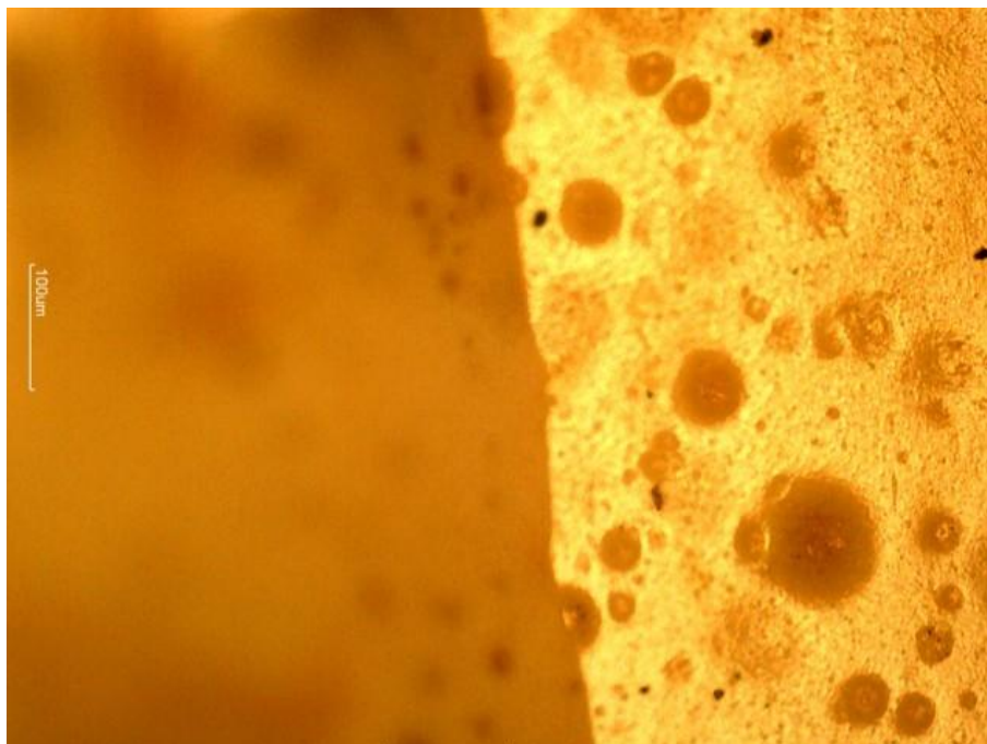
Figura 39. Dano na tinta alquídica após 4 horas em estufa (microscópio 10x)
