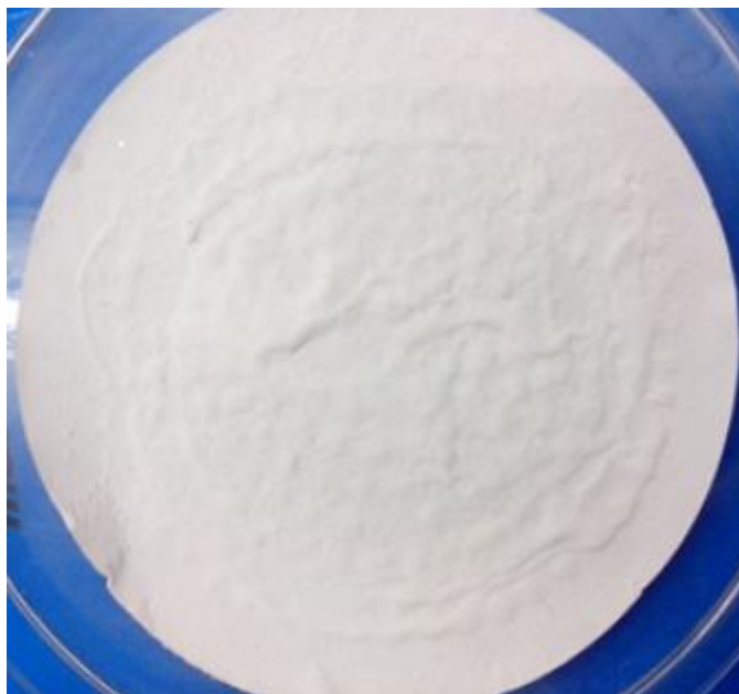
Figura 14. Papel filtro seco contendo as microsferas de PCL obtida por emulsão
