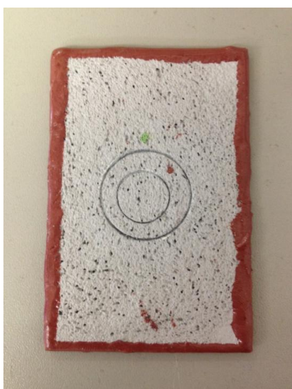
Figura 36. Dano mecânico antes de choque térmico em placa com revestimento de tinta epóxi
