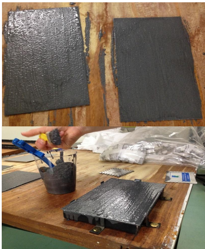
Figura 16. Placas de aço carbono revestidas de uma camada de tinta alquídica aditivada a 20% em massa seca de tinta com microesferas de PCL
