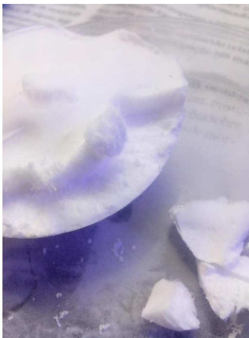
Figura 26. Sólido recuperado após sublimação da água
