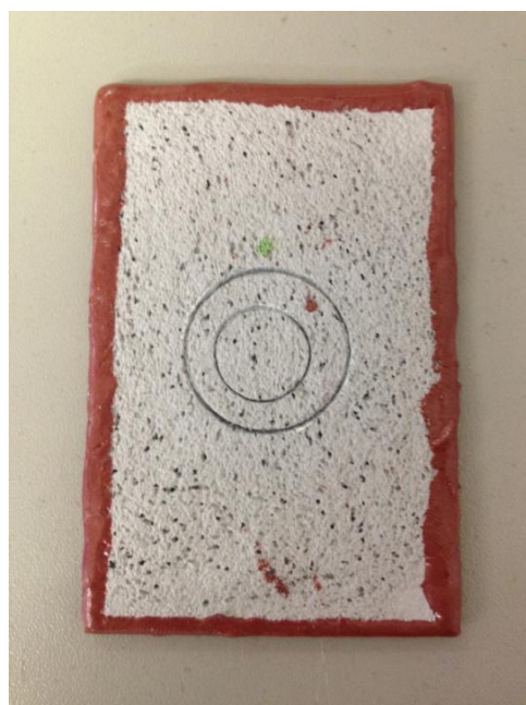
Figura 25. Dano mecânico em placa com revestimento de tinta epóxi
