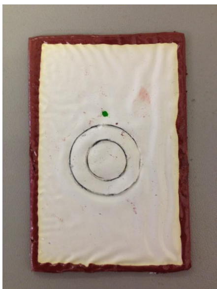
Figura 34. Dano mecânico antes de choque térmico em placa com revestimento de tinta alquídica
