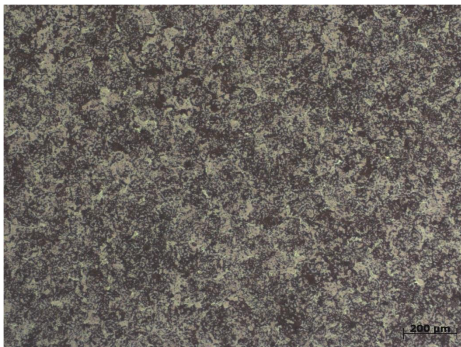
Figura 35 - Imagem de microscópio da impressão a temperatura de prato de 60°C e vazão de 0,2 ml/min de solução com nano partículas lavadas com 70% de etanol
