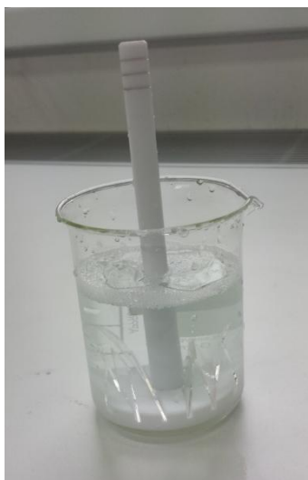
Figura 18 - Imersão das placas no béquer com solução de sabão
