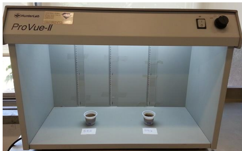
Figura 21 – Câmara de luz com as amostras a serem comparadas quanto à aparência.
