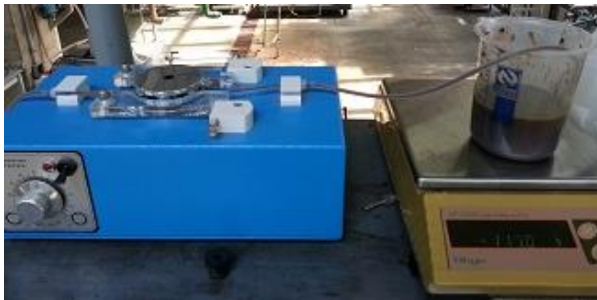
Figura 12 – Amostra de polpa de açaí ligada à bomba peristáltica que empurra a amostra para dentro do disco do atomizador.
