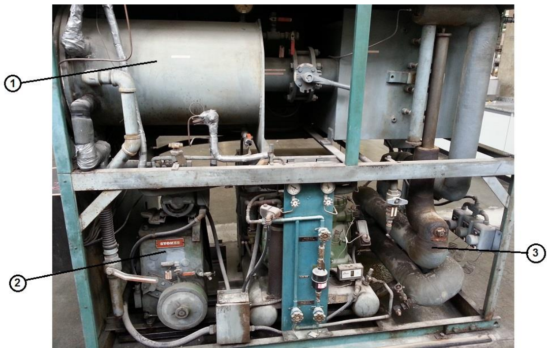
Figura 9 – Visão da parte de trás do liofilizador de Stokes. (1) câmara do condensador; (2) bomba de vácuo; (3) circulação de óleo.
