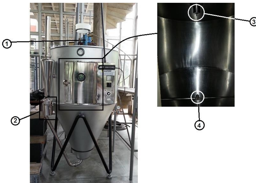
Figura 11 – Equipamento de secagem por atomização APV-ANHYDRO e a parte interna com aspersor superior de um fluido e inferior de dois fluidos. (1) atomizador; (2) recipiente de coleta de amostra; (3) aspersor superior de um fluido; (4) aspersor inferior de dois fluidos.
