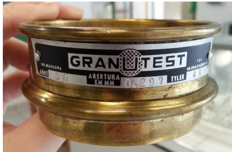
Figura 10 – Peneira utilizada para separar sólidos maiores da polpa de açaí antes de secagem por atomização.
