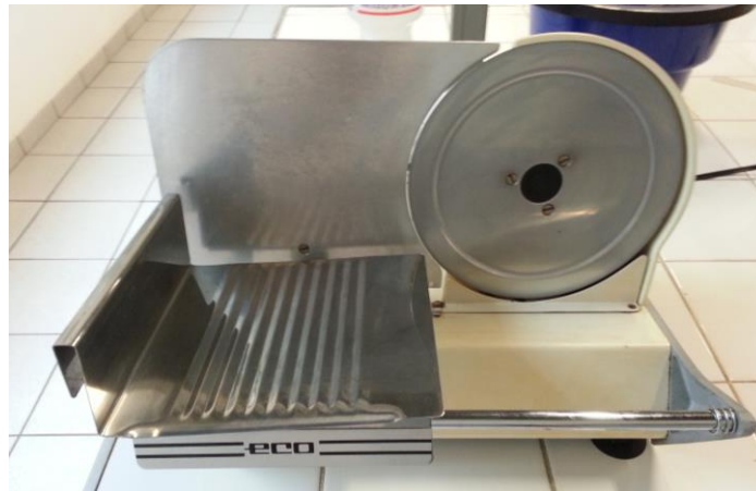
Figura 5 – Fatiador mecânico usado para cortar as frutas com espessura de 5 mm.
