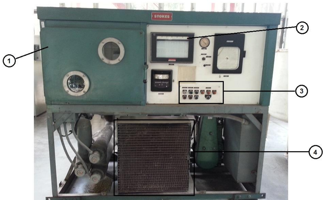
Figura 8 – Visão frontal do liofilizador de Stokes. (1) câmara de secagem; (2) indicador de temperatura dos termopares; (3) painel de controle da refrigeração, bomba a vácuo e aquecimento; (4) sistema de refrigeração.
