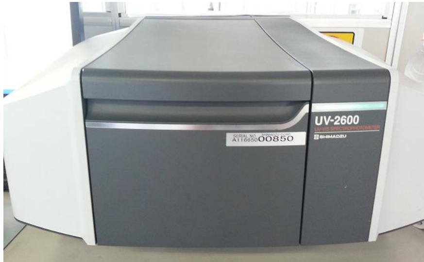
Figura 20 – Espectrofotômetro UV-2600, UV-VIS SPECTROPHOTOMETER, da empresa SHIMADZU.
