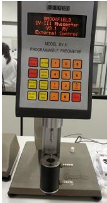
Figura 18 – Reômetro programável, modelo DV III, Brookfield.
