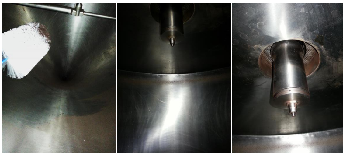
Figura 26 – Açaí retido no interior do atomizador: fundo do equipamento (à esquerda), paredes superiores (centro) e região do aspersor superior (à direita).
