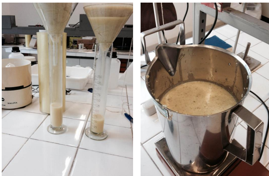
Figura 4.6: Elaboração da solução de pectina utilizada no laboratório para testes
