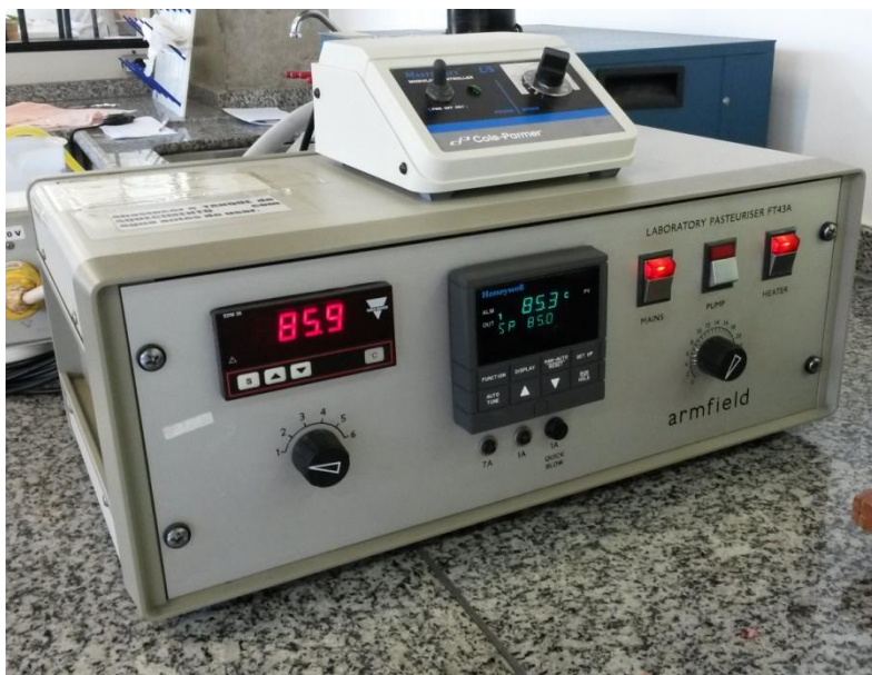
Figura 4.12: Controlador da temperatura de saída do tubo de retenção
