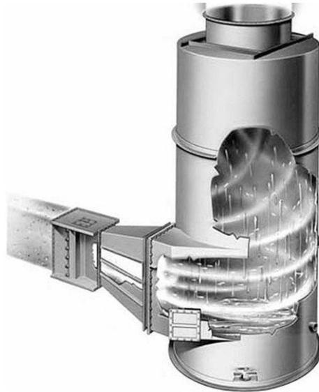
**Figura 3 - Venturi com separador ciclônico acoplado [2]**
