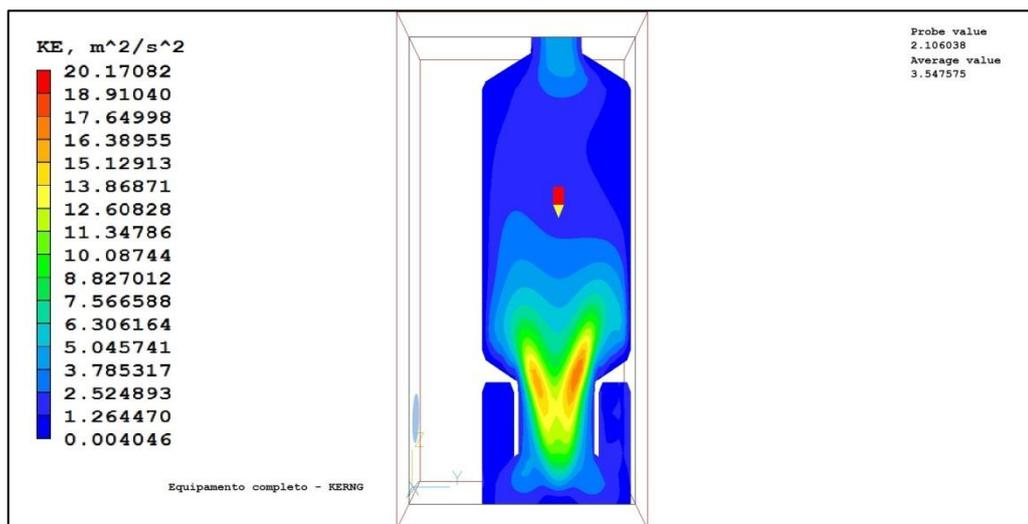
Figura 24 - Simulação monofásica do equipamento completo, perfil de KE
