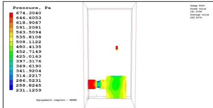
**Figura 21 - Simulação monofásica do equipamento completo, pressão com ênfase no lavador**
