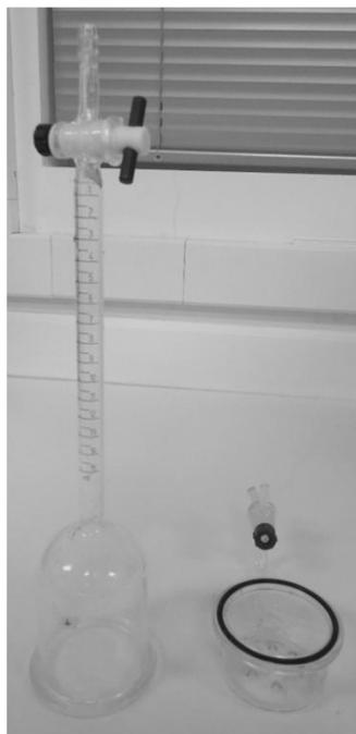
**Figura 24: Vidraria com graduação para auxiliar na medição da quantidade de óleo recuperado.**
