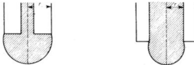
Figura 20: Raio  $r$  do estalagmômetro de acordo com o espalhamento da gota do líquido adotado. Extraído de: <http://zsm.umcs.lublin.pl/Wyklad/FGF-Ang/2A.F.G.F.%20Surface%20tension.pdf>. Acessado em Agosto de 2014.
