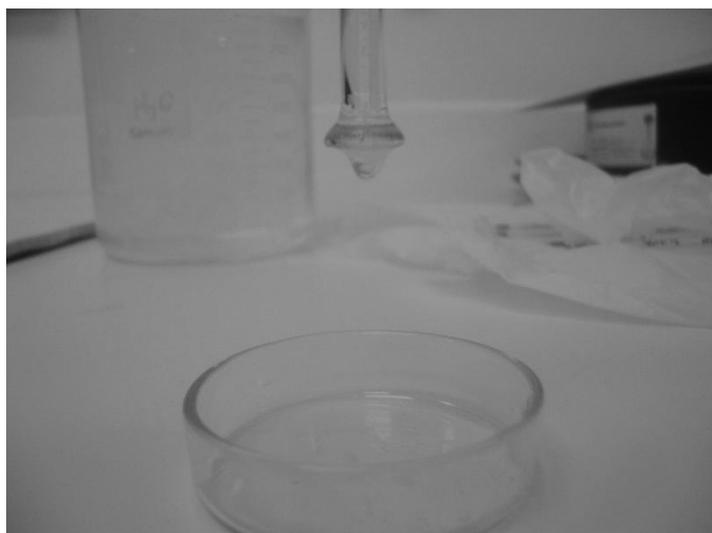
Figura 21: Andamento do teste de tensão superficial pelo método estalagmômetro.
