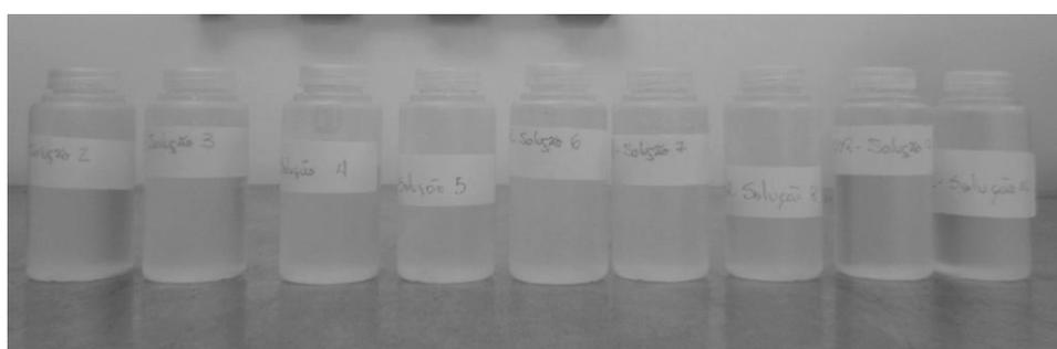
Figura 18: Frascos com soluções de surfactantes para o teste de compatibilidade mostraram estabilização.
