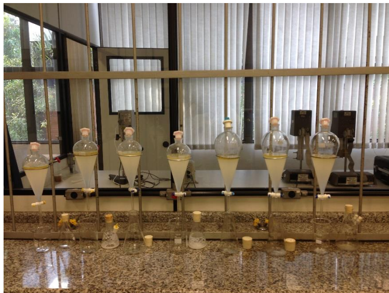
Figura 25 - Funis de separação com os produtos das reações e ácido clorídrico após agitação.
