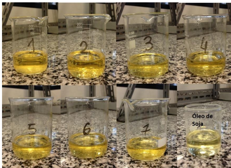
Figura 29 – Foto do biodiesel obtido em cada um dos ensaios e foto do óleo de soja.
