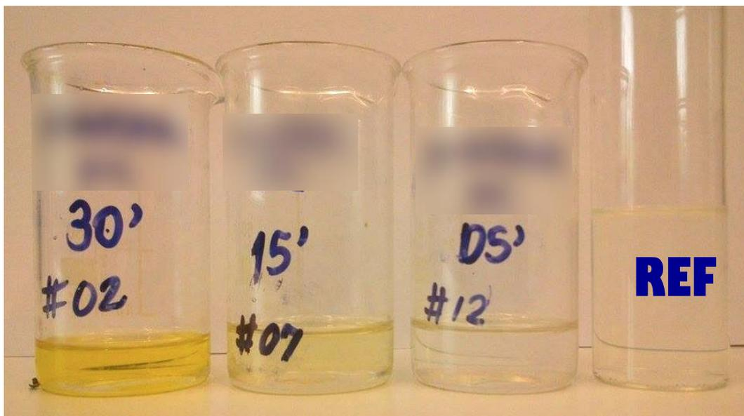
Figura 15. Fluido de corte MWF2 após ser submetido a 20 ciclos de aquecimento na faixa de 150-160°C
