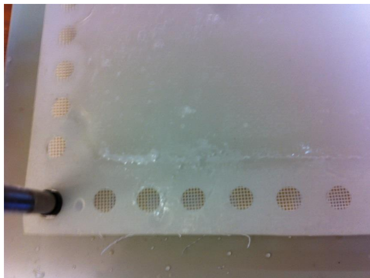
Figura 34. Superfície de uma membrana com deposição de sal após um experimento.
