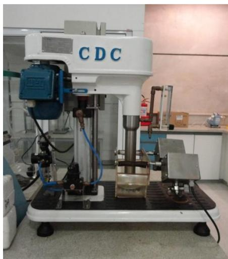
Figura 11: Célula de flotação CDC
