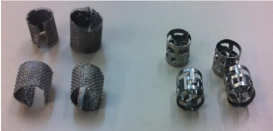
Figura 22 - Recheio Anel de Raschig Modificado (esquerda) e Pall Ring (direita)
