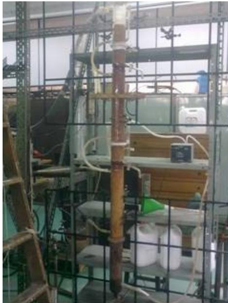
**Figura 6 - Foto da coluna de extração utilizada no experimento.**
