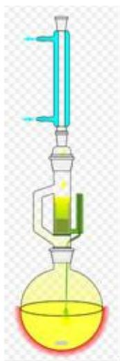
**Figura 7 - Esquema do Soxhlet utilizado no experimento.**
