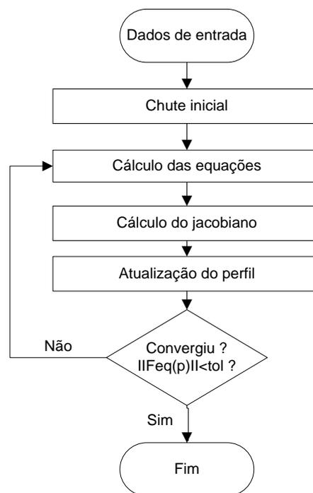
**Figura 6 - Diagrama de blocos do método de Ketchum**
