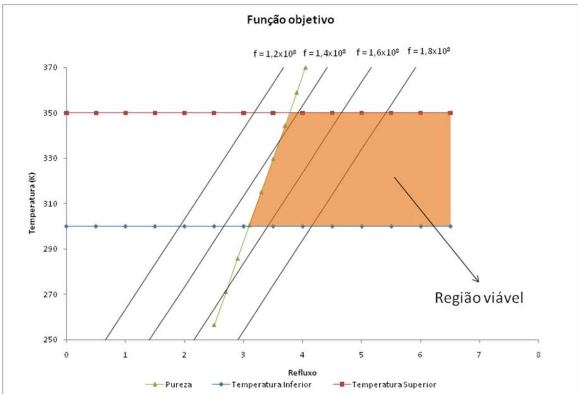
**Figura 22 - Curvas de nível e restrições da função objetivo**
