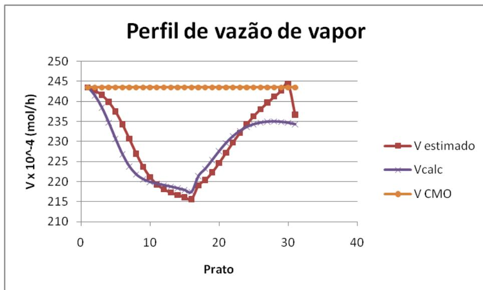
Figura 16 - Perfil de vazão de vapor
