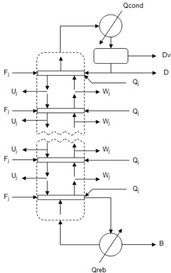
**Figura 4 - Esquema de uma coluna de destilação**
