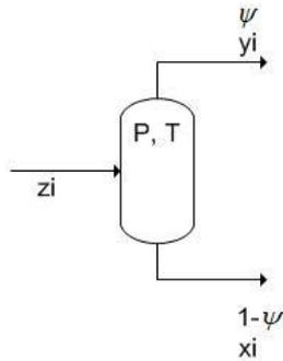
Uma corrente parcialmente vaporizada (F) é alimentada em um tambor flash, no qual ocorre a separação das fases vapor e líquida. Através das relações de ELV, é possível se calcular a composição das duas fases que deixam o tambor e a fração vaporizada da corrente de alimentação.
