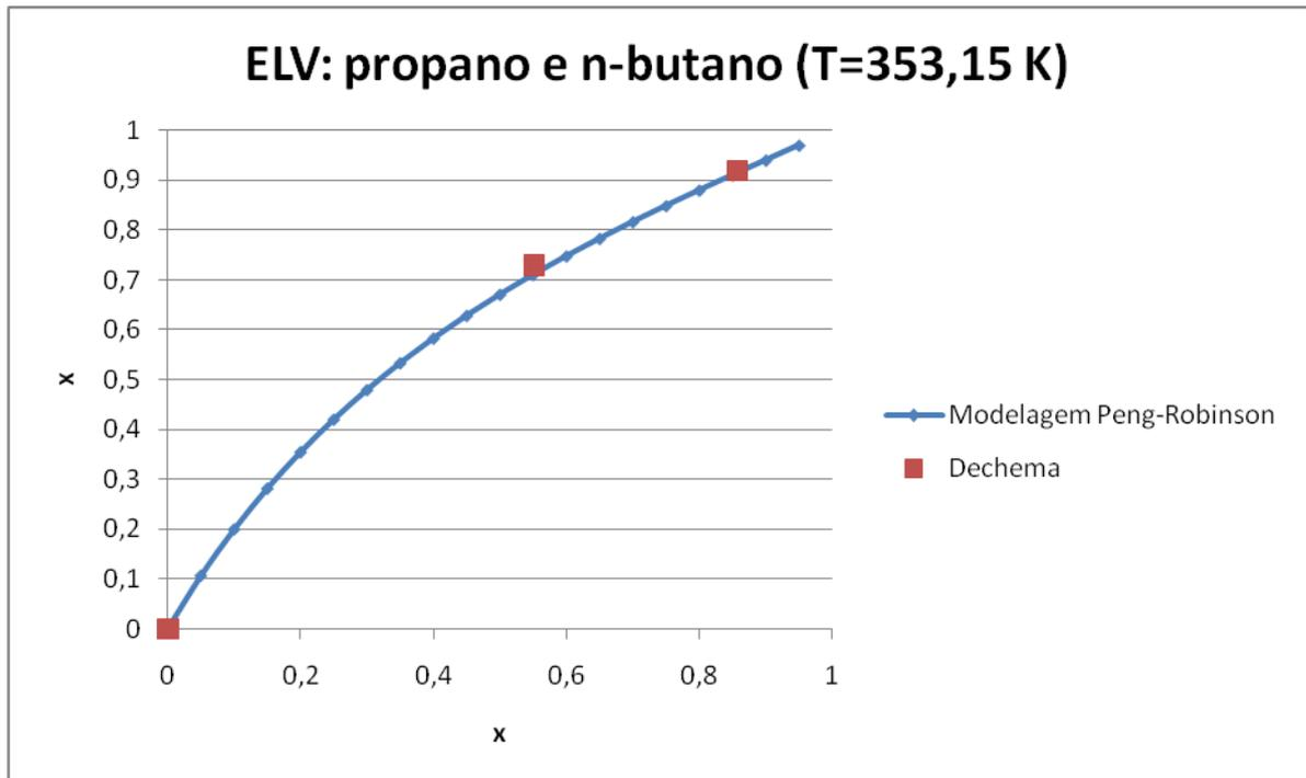
**Figura 10 - Modelagem do ELV por Peng-Robinson (T = 353,15 K)**
