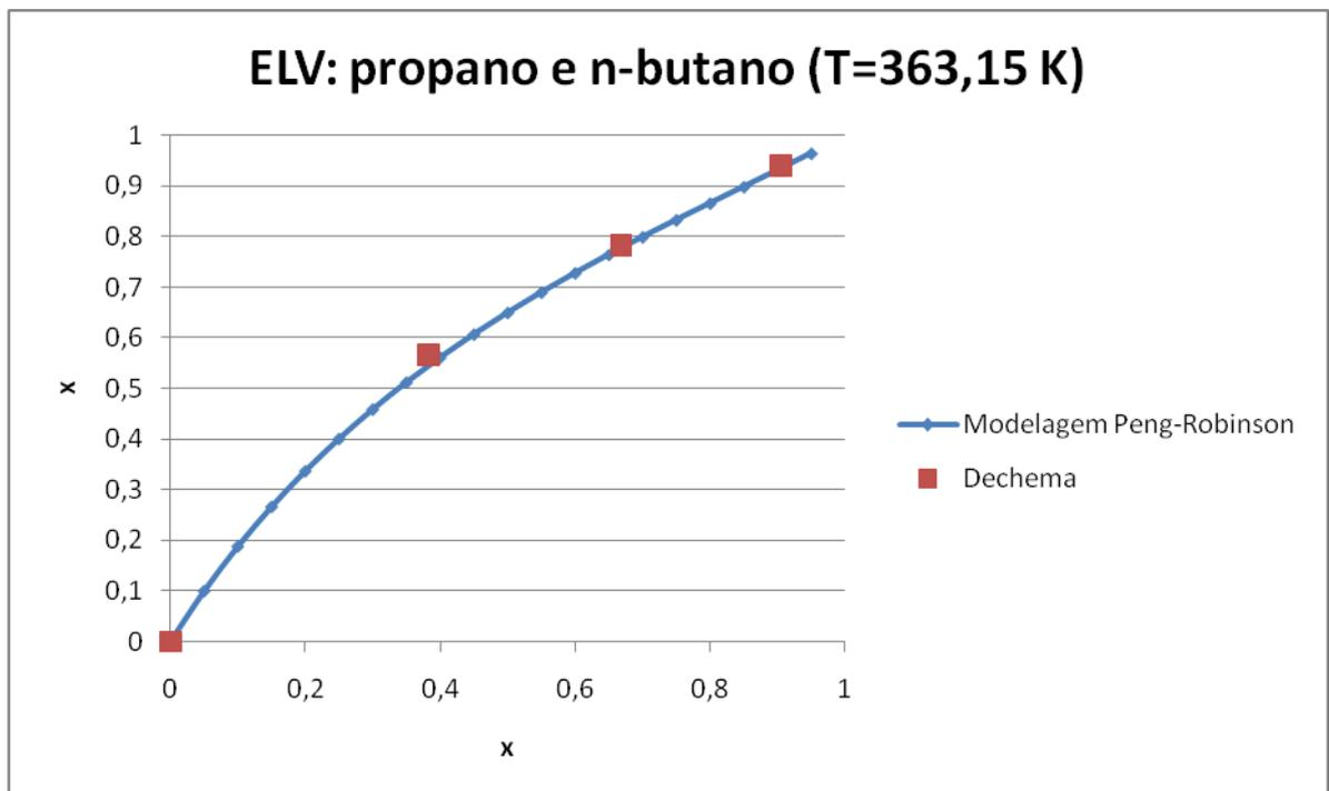
**Figura 11 - Modelagem do ELV por Peng-Robinson (T = 363,15 K)**
