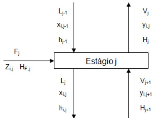
Figura 5 - Esquema de um estágio de equilíbrio
