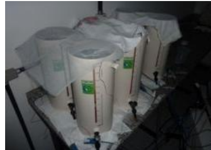
Foto 17 - Mostos recém extraídos com termopares instalados
