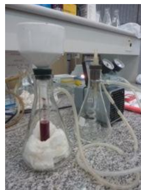
Foto 52 - Esquema de filtração a vácuo
