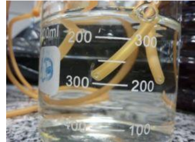
Foto 41 - Saída de gás na fermentação fechada através da mangueira plástica
