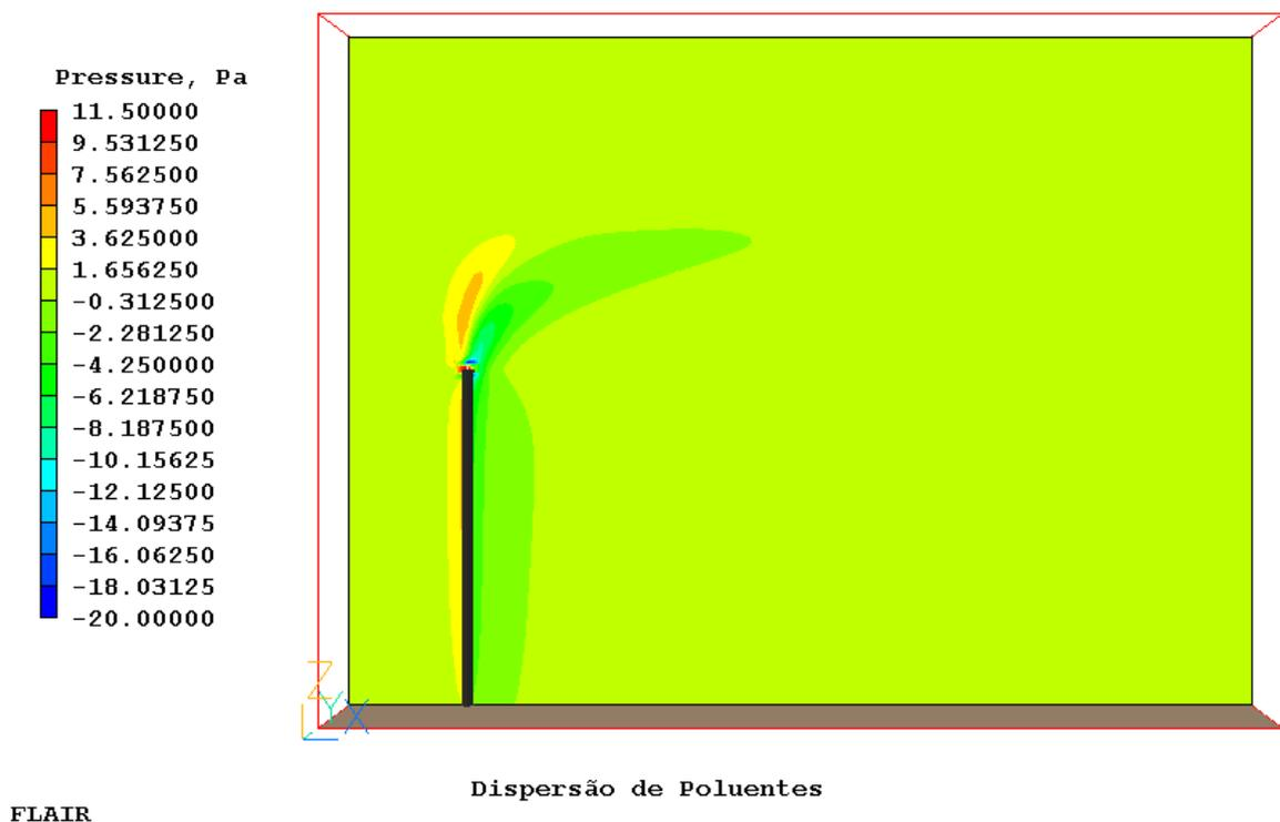
Figura 7. Perfil de Pressão no plano xy.
