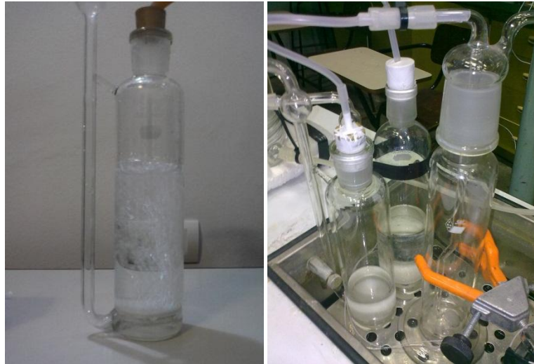
Figura 8 - Frascos dotados de placa porosa - Um frasco e três frascos em série
