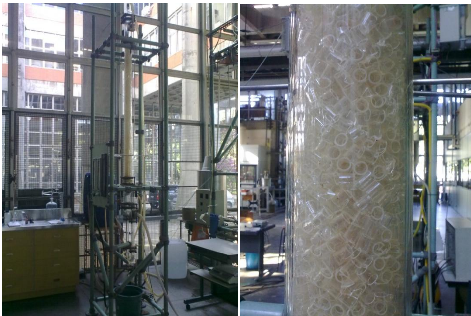
Figura 3-coluna de absorção (à esq.) e recheio de anéis de Raschig de vidro de 3/8" (à dir)
