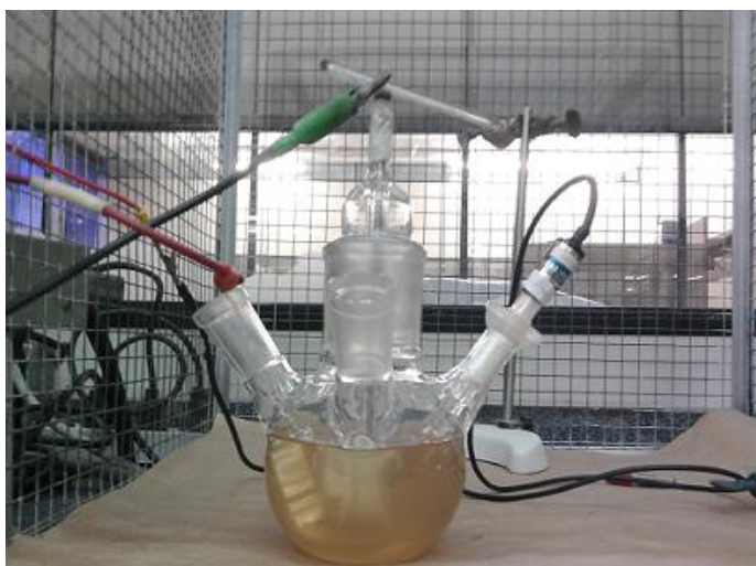
Figura 23 Cella eletrolítica composta de três eletrodos.
