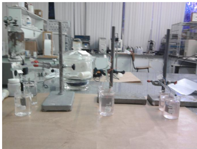
Figura 34 Ensaios de imersão para analisar o ângulo de contato.
