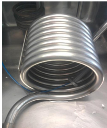
Figura 39 - Trocador de calor utilizado no experimento realizado
