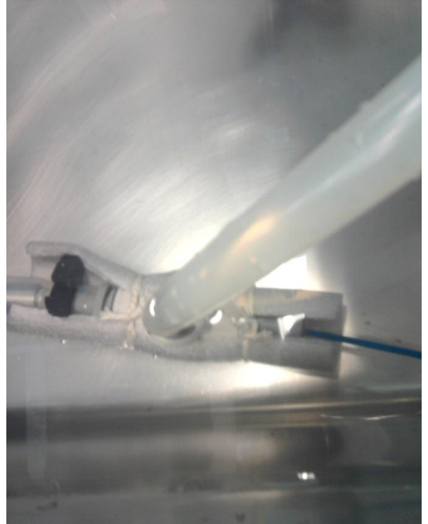
Figura 38 - Camada de isolante térmico na tubulação posterior ao trocador de calor (Termopar 2)
