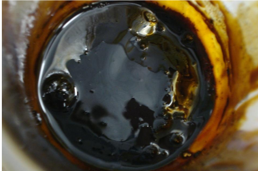
Figura 40 – Aspecto do óleo extraído de borra de café em tanque agitado após evaporação total do etanol excedente
