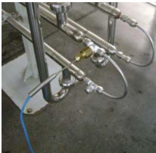
Figura 5 - Termopar inserido na linha do produto
