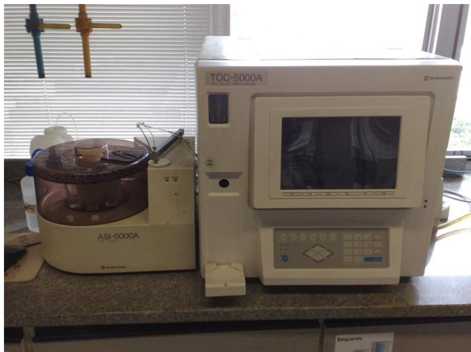
Figura 11 - Analisador de carbono (Shimadzu 5000A).
