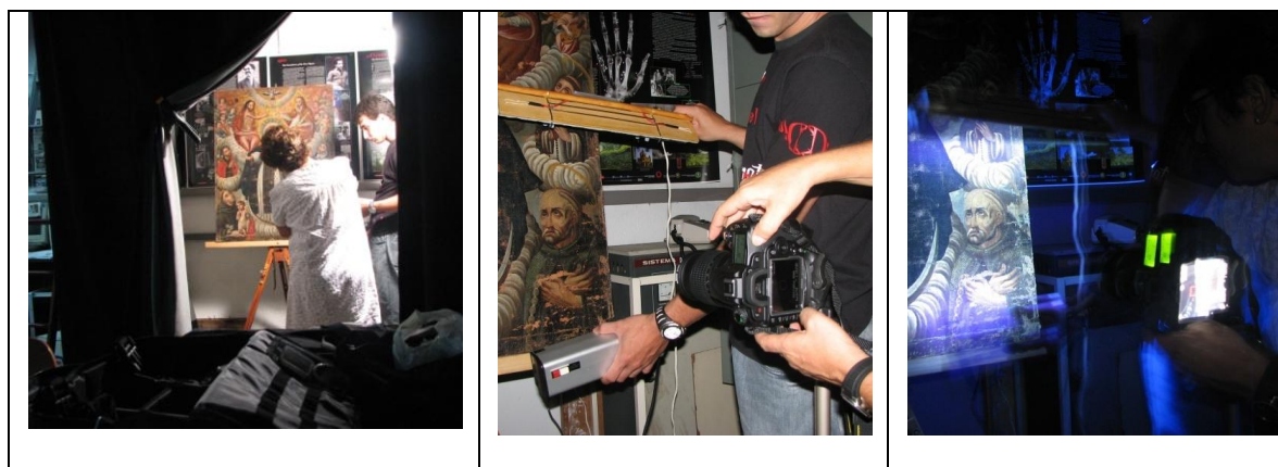
Figura 5 – Esquerda: cabine escura em nosso laboratório na EPUSP. Centro: Fotografia com luz visível. Direita: Fotografia com luz ultravioleta. Tela cuzquenha sob restauro de Elizabeth Kajiya. Equipamento de iluminação e fotografia da restauradora e do IFUSP.
