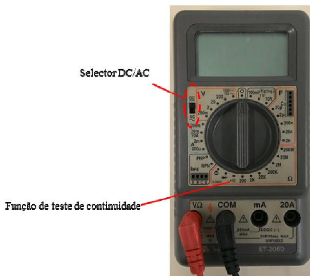
Figura 2 – Multímetro Minipa ET-2060
