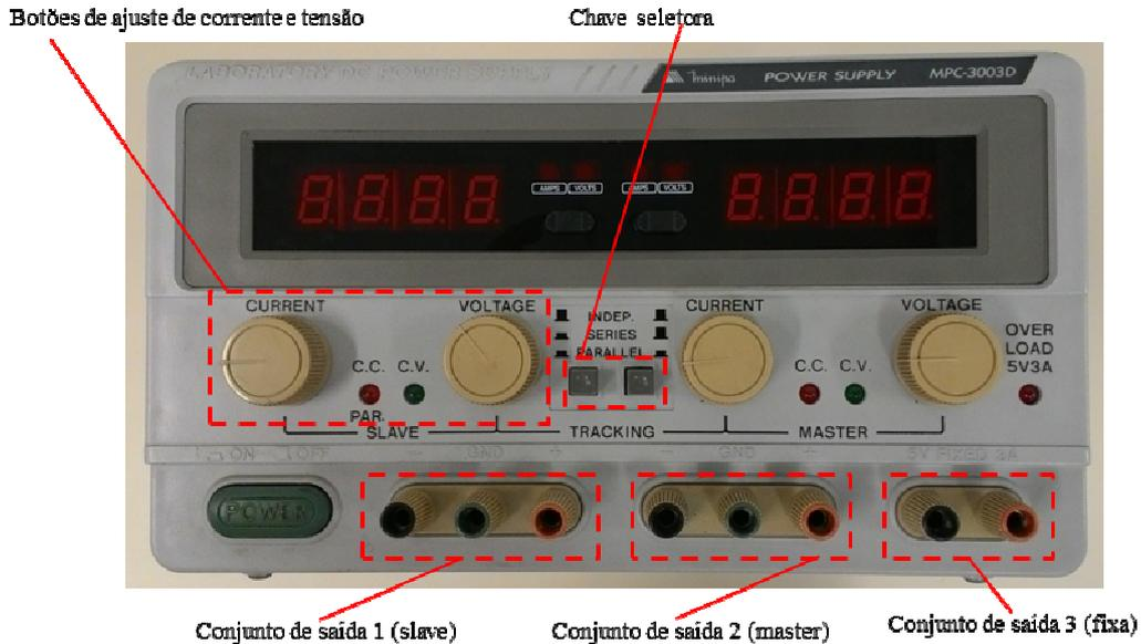
Figura 4 – Fonte de alimentação Minipa MPC-3003D
