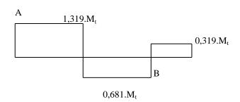
Verificar onde ocorre tensão máxima nos trechos A e B, pois em A é onde tem-se o maior esforço e em B, onde tem-se um diâmetro menor que o de A.
