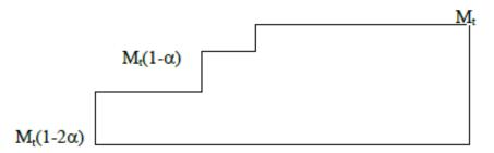
4) Calcular qual deve ser a posição (a = ?) da carga torçora (T) para que as tensões de cisalhamento máximas nos trechos AB e CD sejam iguais.
