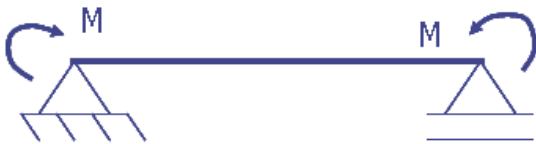
Fig. 6.5 Exemplo de viga com flexão pura
