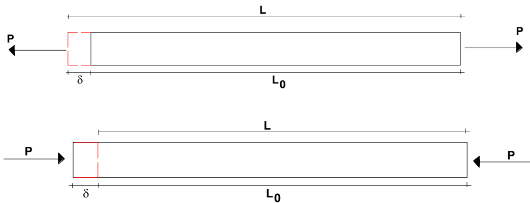
FIG. 4.2 Alongamento e encurtamento de uma barra
