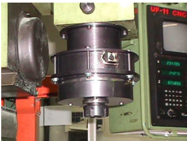
Figura 5 Fluxograma e ilustração do sistema proposto e construído para aquisição do sinal de EA.
