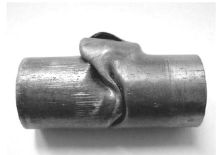
Figura 14 - Flambagem e fratura
