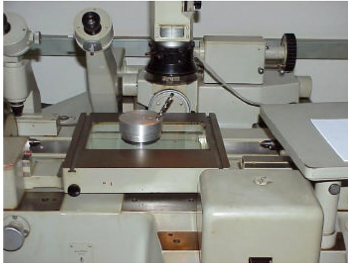
Figura 5 - Medição do desgaste da broca utilizando um microscópio JENA 3313.
