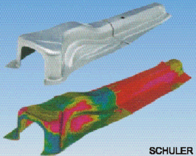
túnel longitudinal de automóvel
