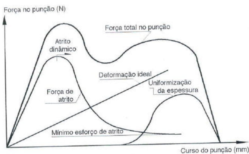
Figura 5 : tipos de esforços envolvidos na estampagem profunda.
