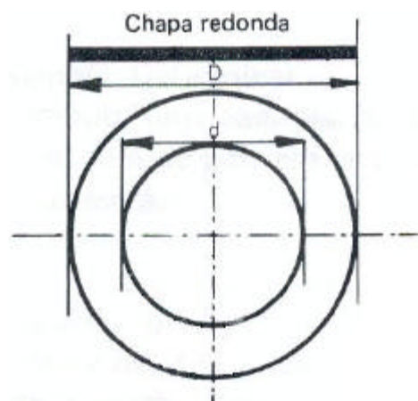
Figura 1: Esquema da área submetida à deformação na operação de estampagem profunda.
